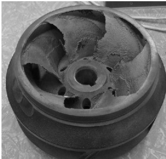
1. ábra. Szivattyú járókerékén kavitáció okozta erózió
