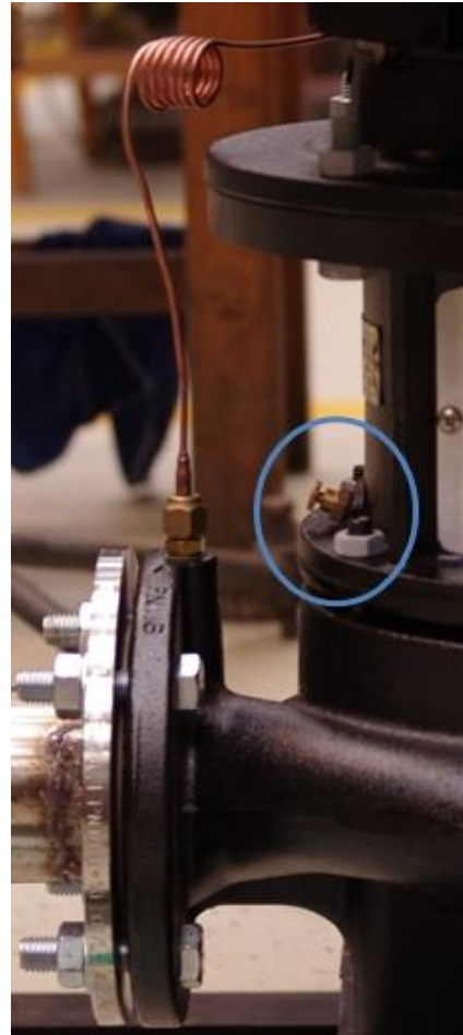
3. ábra. bal oldal: örvényszivattyú-villanymotor-frekvenciaváltó gépcsoport, jobb oldal: csigaház légtelenítő szelepe
