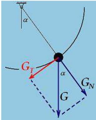
Die Schwingung des Pendels wird durch die Newtonschen Axiomen beschrieben. Betrachten wir die Bezeichnungen der Abbildung! Die den Körper beschleunigende Tangentialkraft  $G_T$  kann aus dem Gewicht der schwingenden Masse, als  $G_T = G \cdot \sin(\alpha)$  berechnet werden, wobei  $G = m \cdot g$ . Das zweite Axiom von Newton behauptet, daß die Kraft gleich Masse mal Beschleunigung ist,  $m \cdot a_T = G_T$ , d.h.
