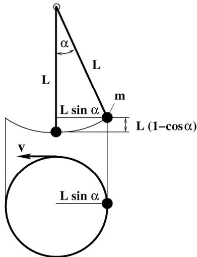
A **matematikai inga** egy súlytalan és nyúlhatatlan,  $L$  hosszúságú fonalon lengő  $m$  tömegű tömegpont. A légellenállást és a felfüggesztésnél ebredő súrlódást elhanyagoljuk. A kitérés szöge „kicsi” (lásd később).
