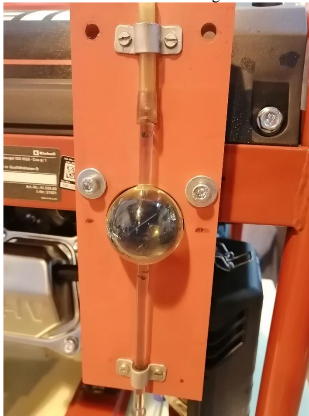
Meßgefäß zur Messung des Benzinverbrauchs
