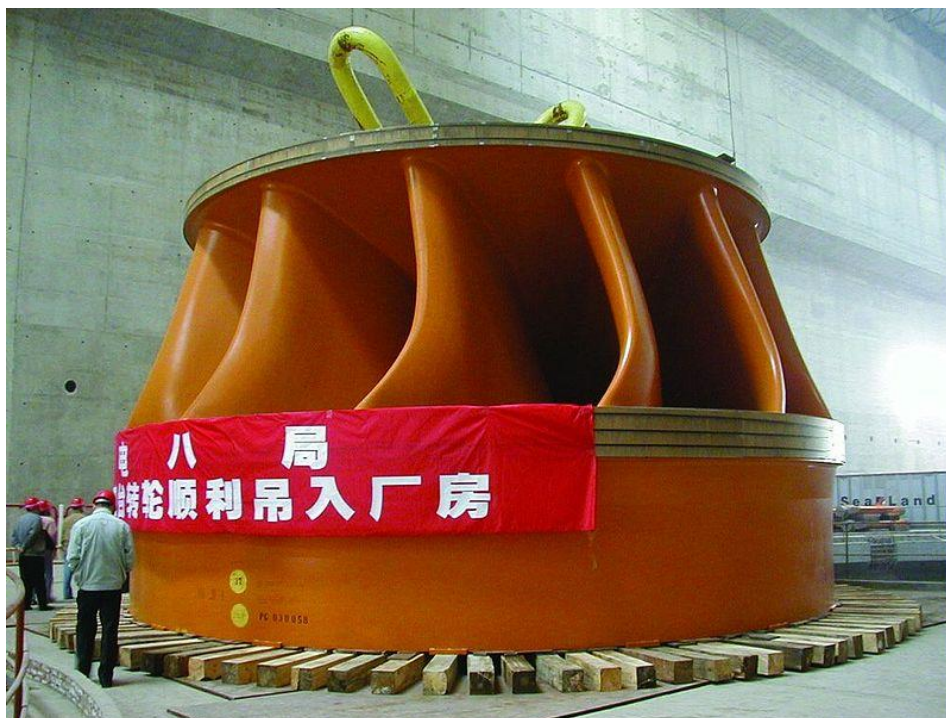
Three Gorges Vízermű (Kína) Francis turbina járókere. Az erőműben 26 Francis turbina működik
