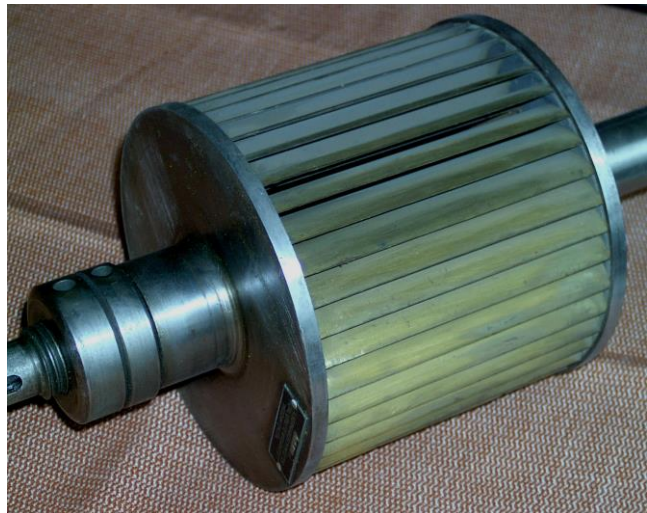
Bánki turbina járókerék ipari műemlék, Bánki Donát ezen végzett kismintakísérleteket
