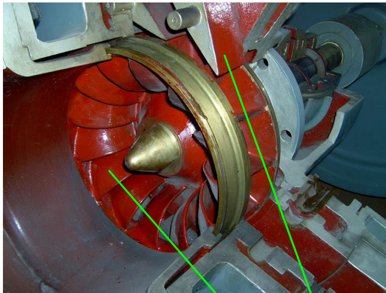
„ Gyors ” járású Francis turbina járó + vezetőkeréke Az (5) képlet szerinti jellemző fordulatszám értéke nagy .
