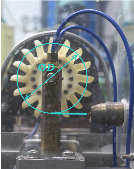
4. kép A Pelton turbina kerékátmérője és egy Pelton kanál A fűvőkából kilépő vízszugár a \text{ØD} átmérőn éri el a turbinakerék lapátokat
