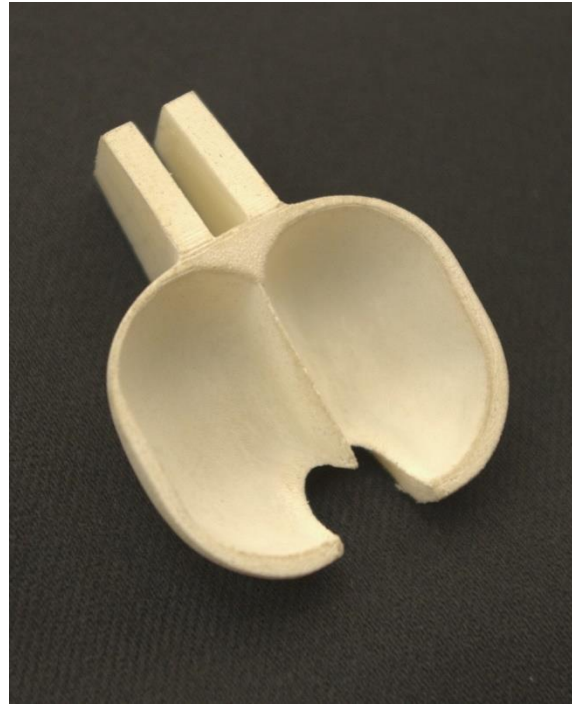
4. kép A Pelton turbina kerékátmérője és egy Pelton kanál A fűvőkából kilépő vízszugár a \text{ØD} átmérőn éri el a turbinakerék lapátokat
