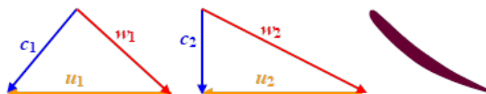
8.8.2. ábra Kaplan turbina sebességi háromszögei és egy turbinalapát metszete
