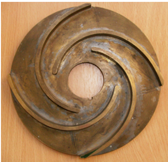
2.1.a ábra 5-lapátos radiális átömlésű járókerék rajza, a c abszolút , w relatív és u kerületi sebesség, az abszolút sebesség kerületi komponensének megváltozása, 2.1.b. ábra 4-lapátos bronz járókerék képe
