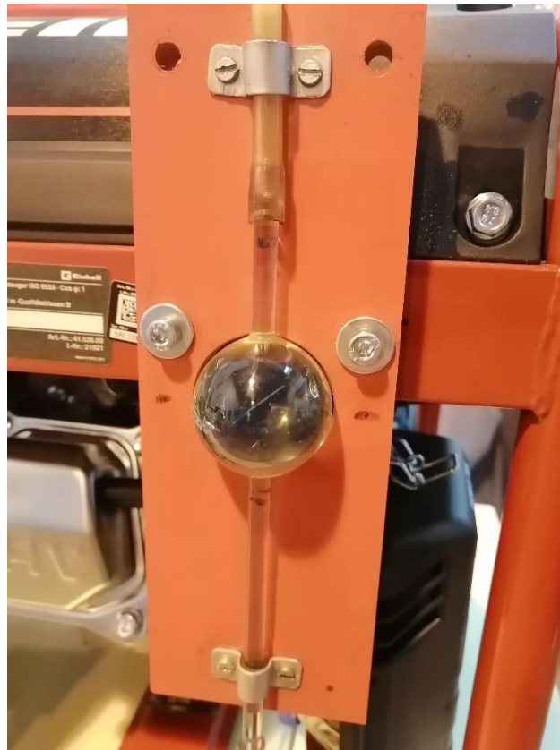
Köböző edény az üzemanyag fogyasztás méréséhez
