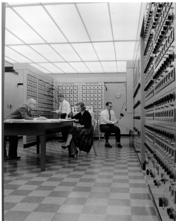
2.5. ábra. McIlroy Network Analyzer üzem közben 1958-ban (Forrás: [7]).
