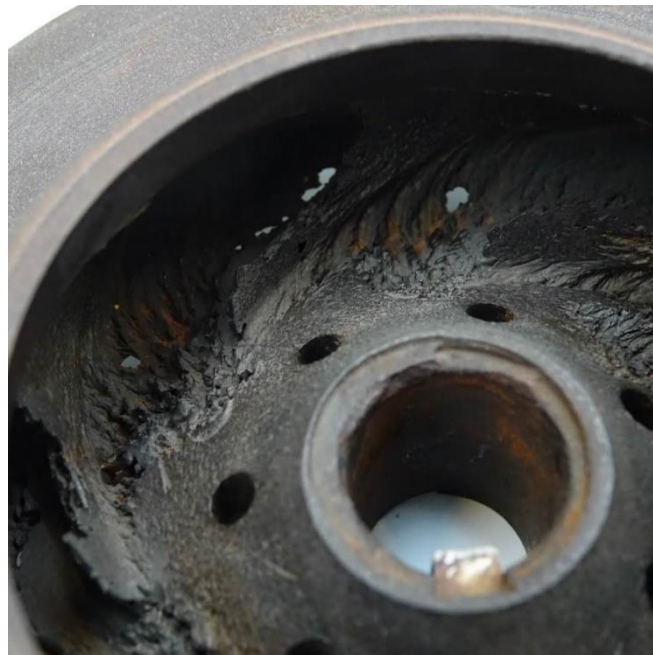
1. ábra. Szivattyú járókerékén kavitáció okozta erózió
