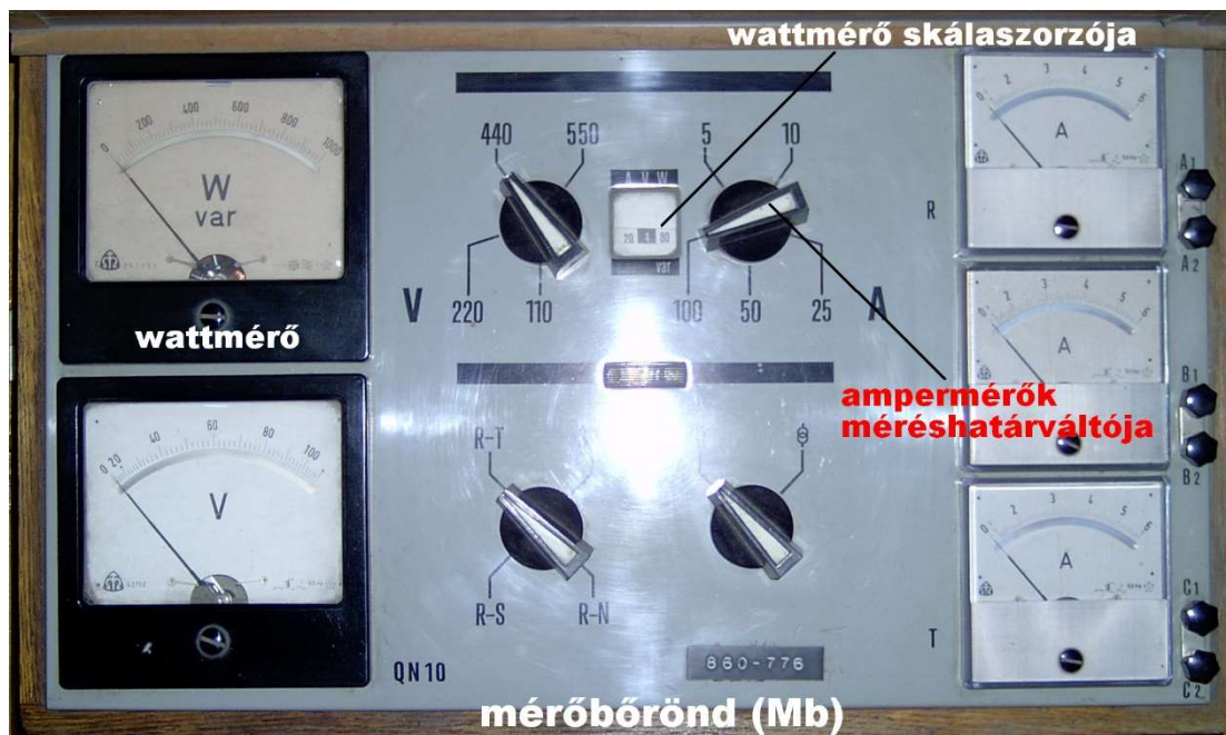
3. kép A mérőbörönd fontosabb elemei
