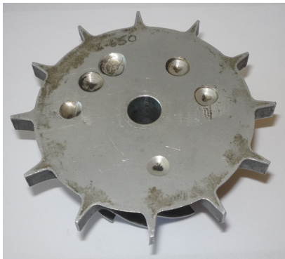
Centrifugál kompresszor hátlapja dinamikus kiegyensúlyozás során készített furatokkal
