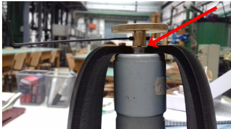
1. ábra Motor a tartóváza szerelve. Ügyeljünk az agy és a póttömeg közti, piros nyíllal jelzett részre.
