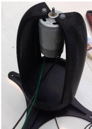
1. ábra Motor a tartóváza szerelve. Ügyeljünk az agy és a póttömeg közti, piros nyíllal jelzett részre.
